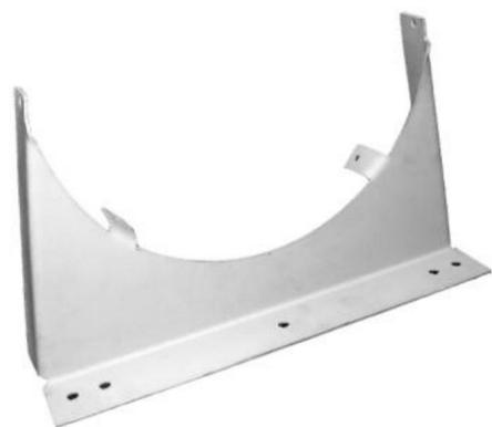
Кронштейн КК для круглых канальных вентиляторов предназначен для монтажа вентилятора к плоской поверхности. Кронштейн имеет отверстия для крепления к корпусу вентилятора и монтажные отверстия для крепления кронштейна к плоской поверхности. Кронштейн изготовлен из стали окрашенной в цвет корпуса вентилятора.
